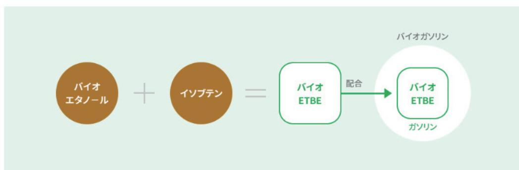
バイオETBE（「エチル・ターシャリー・ブチル・エーテル」の略称）は、エタノールと異なり水分や蒸気圧の管理が必要なく、ガソリンになじみやすい性質を持っているため、ガソリンに7%程度まで混合しても自動車の性能に影響がないことが確認されています。
